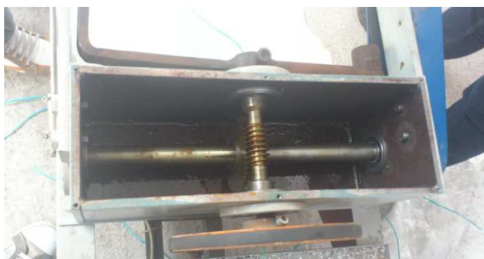
Fig.1 Sistema de Ejes Cruzados (Tornillo sin Fin).
