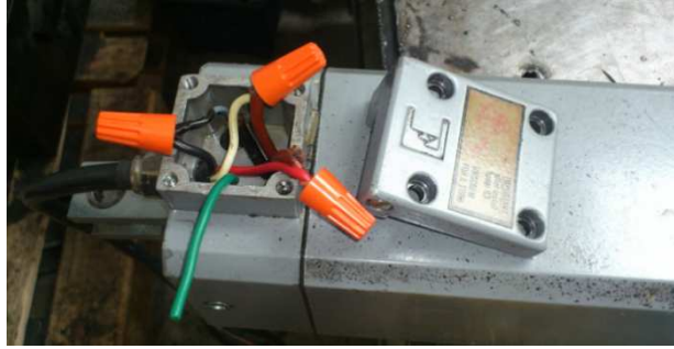
Fig. 2 Cámara de Conexión Eléctrica y Alimentación de Aceite.
