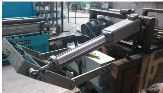
Figura II- 78. Montaje Final del Pistón Hidráulico
