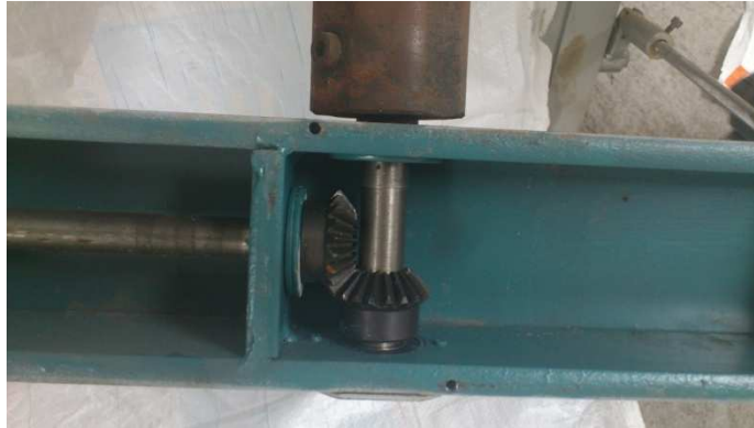
Figura III- 73. Montaje Engranajes Tipo Corona
