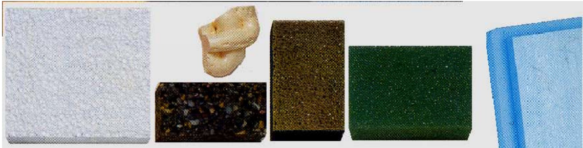
Figura II- 6. Productos Obtenidos por Método de Espumado
