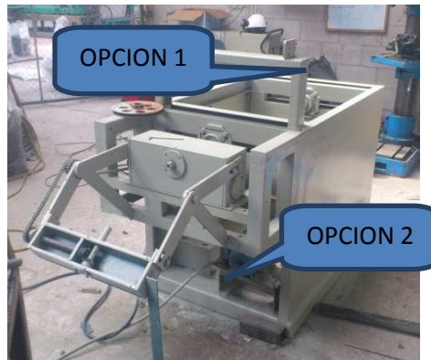
Figura III- 77. Opciones de Colocación de Pistón Hidráulico
