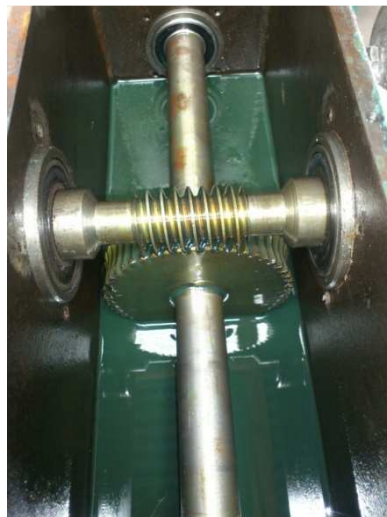
Figura III- 72. Engranaje sumergido en Cámara de Aceite
