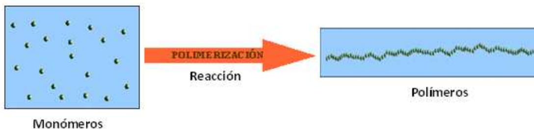
Figura II- 1. Proceso de Polimerización de un Polímero Plástico
