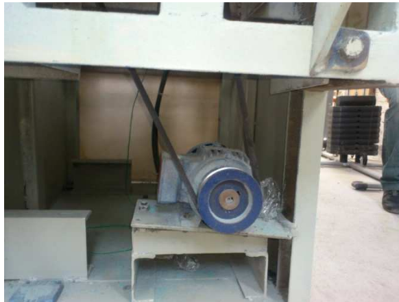
Figura III- 74. Montaje Transmisión Tipo Polea
