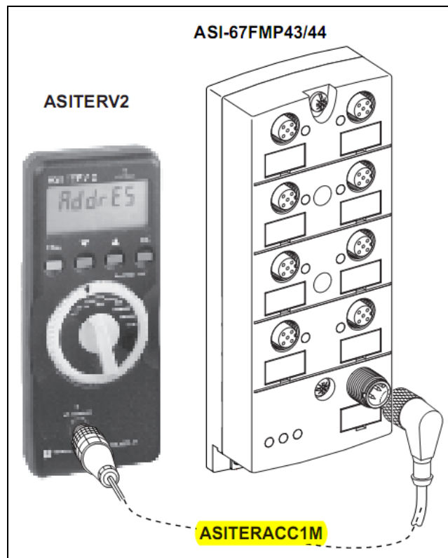
Figura IV.60 Ejemplo de direccionamiento de un esclavo ASi 69
