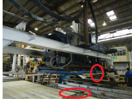
Fig. III.68. Sensor cilindro lámina baja y placa de activación
