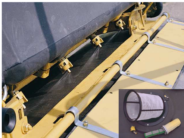
Figura 3.15. Sistema de aspersión de agua para limpieza.
