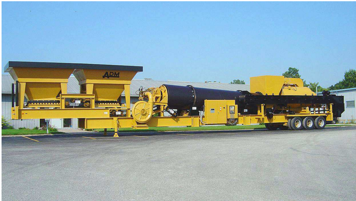
Figura 3.17. Planta de Asfalto.
