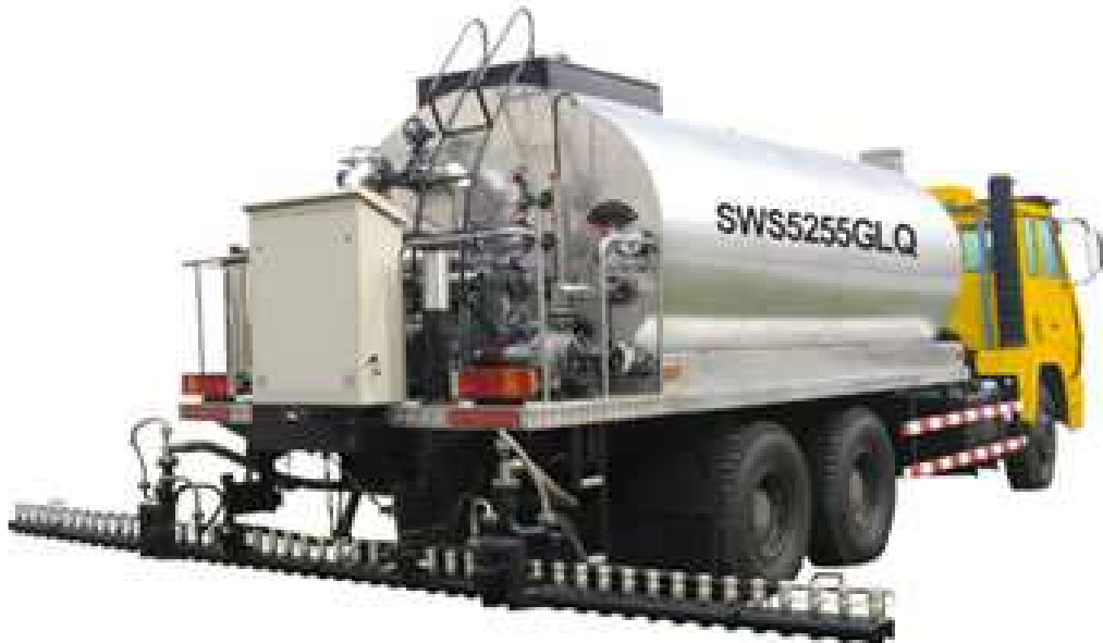
Figura 3.18. Camión con barra de distribución.
