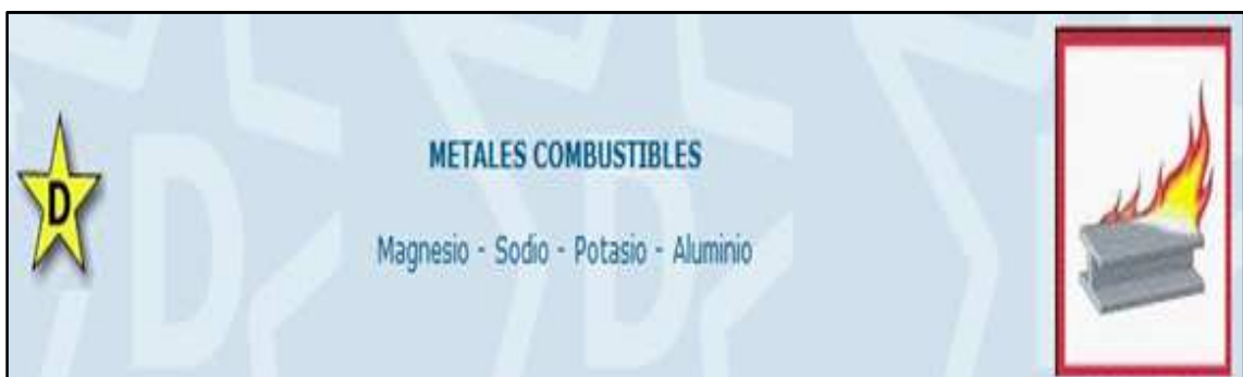
Figura 13. Incendio tipo D
