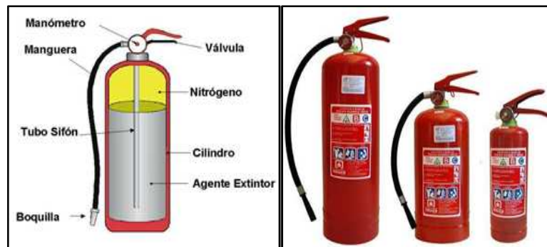
Figura 15. Extintores portátiles (E.P)
