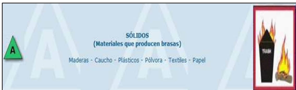
Figura 10. Incendio tipo A
