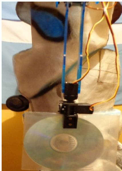
**Fig.VI.49:** Movimiento de la pinza y agarre.
