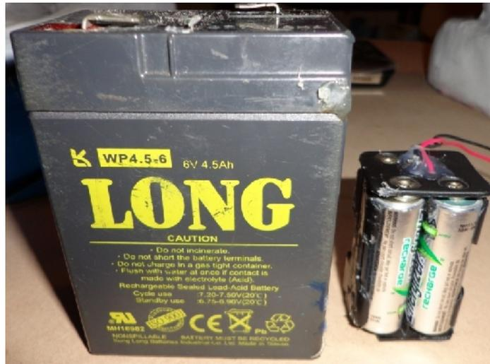
Fig. V.26: Alimentación del circuito principal.
