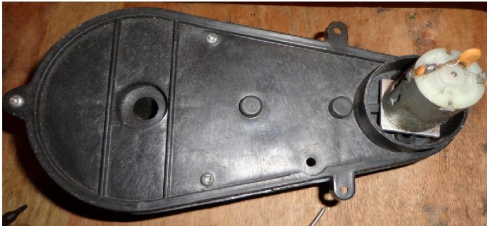
**Fig.IV.14:** Motor utilizado para la tracción diferencial.
