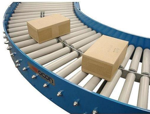
*Figura II.XXI. Banda transportadora accionada por gravedad.*
