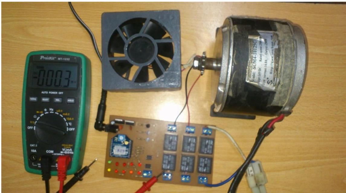
Figura V. 45 Prueba del Módulo de Actuadores
