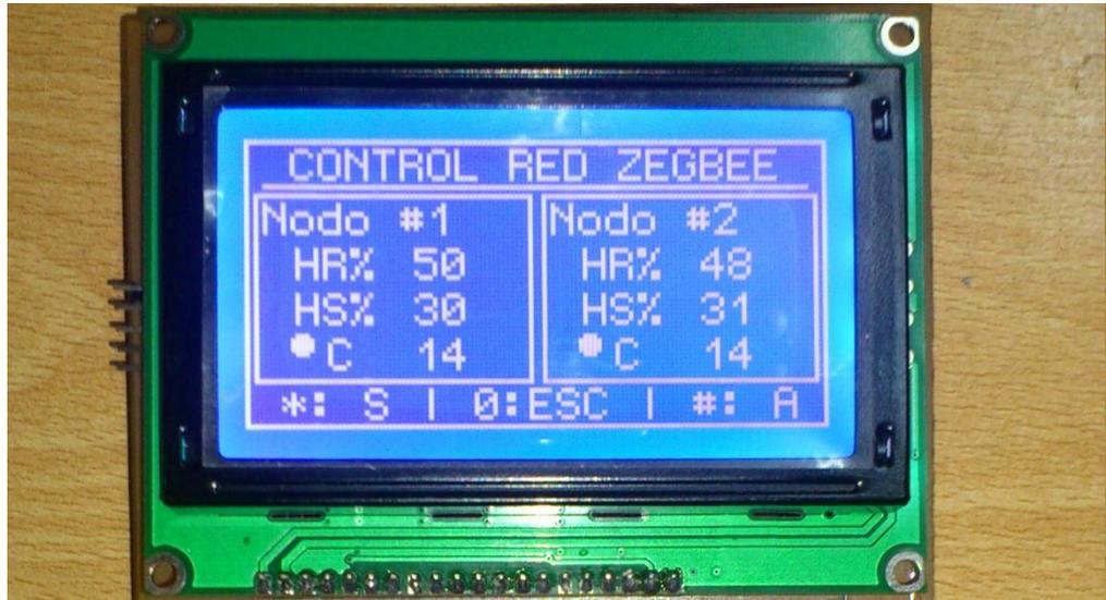
Figura V. 49 Pantalla de Sensores
