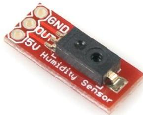
Figura II. 16 Sensor de Humedad HIH-3040
