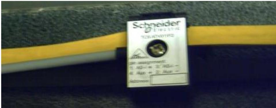
**Figura IV.15** Conexión del vampiro<sup>61</sup>
