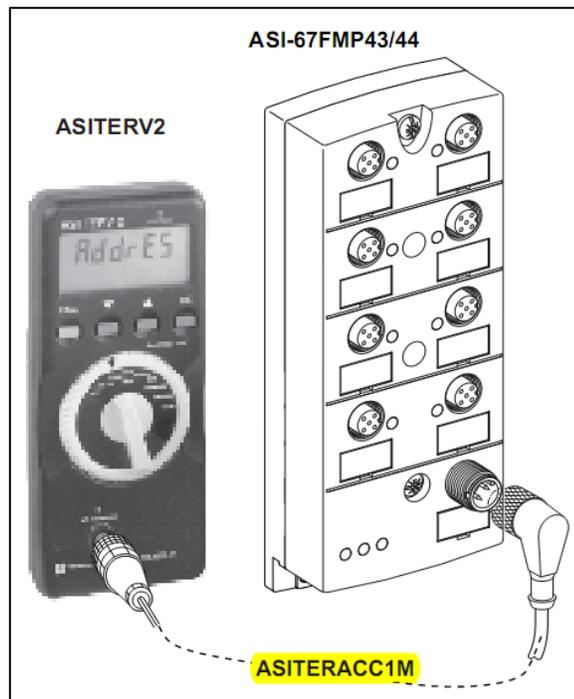
**Figura IV.11** Ejemplo de direccionamiento de un esclavo AS-i<sup>57</sup>
