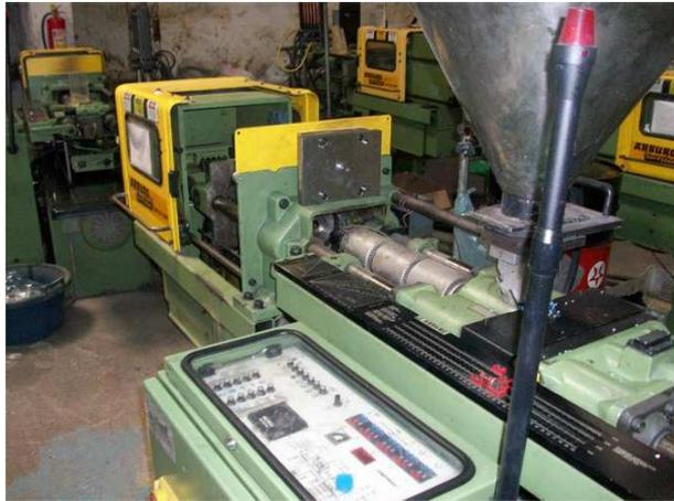
**Figura 6.1 Inyectora ARBURG 221-55-250**
