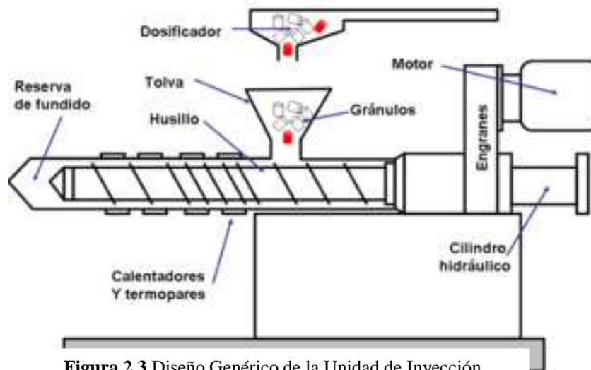
**Figura 2.3** Diseño Genérico de la Unidad de Inyección.
