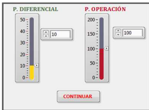
Figura 51. Presuretrol de operación PF
