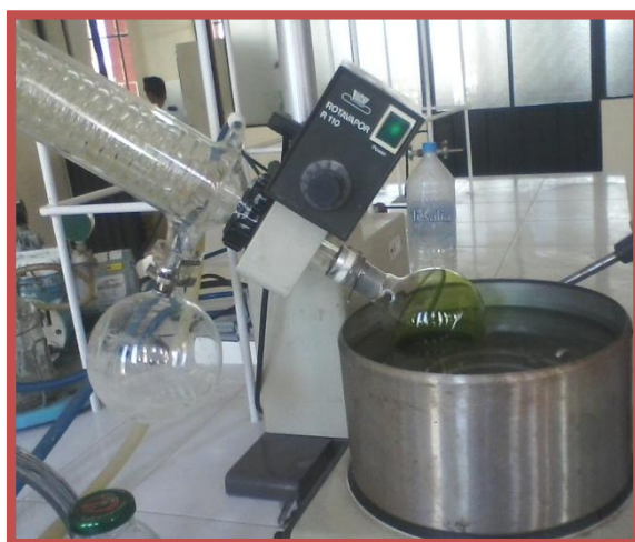
FUENTE: Riofrío Katty. Facultad de Ciencias ESPOCH FOTOGRAFIA No. 5 . CONCENTRACIÓN DEL EXTRACTO
