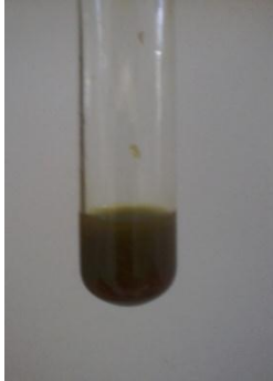
ENSAYO DE CLORURO FÉRRICO
