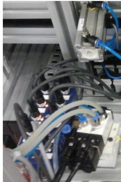
Figura V.40 Conexión con Red AS-i de entradas y salidas<sup>87</sup>
