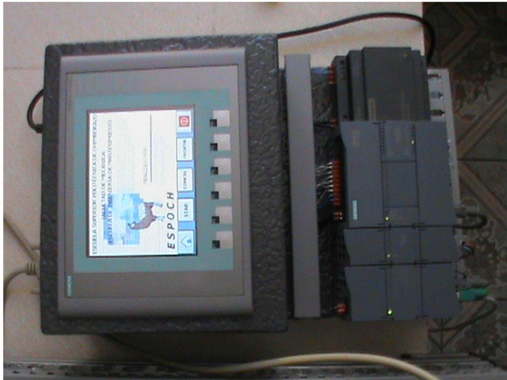
Figura 27. Montaje de los equipos a la estación de programación.
