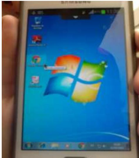
**Figura III. 17 Funcionamiento de XenDesktop en celular Samsung Galaxy S2**
