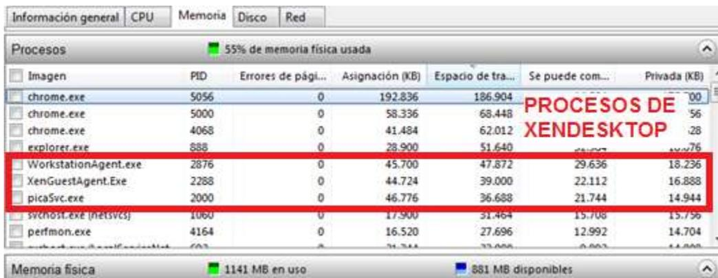
Figura IV. 6 Procesos de XenDsktop en un ambiente virtualizado
