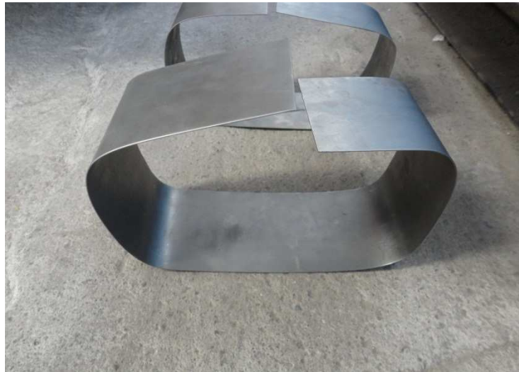
Figura 47. Proceso de barolado plancha principal del silenciador
