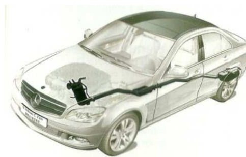
Figura 3. Línea de escape
