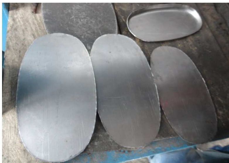
Figura 49. Prensado de compartimientos del silenciador
