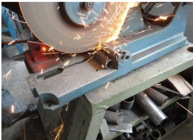
Figura 51. Cortando tubo interior del silenciador
