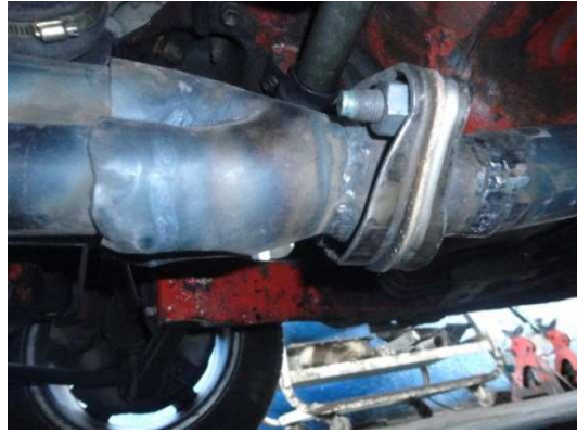
Figura 69. Unión de tubo de escape con el header a través de tornillos
