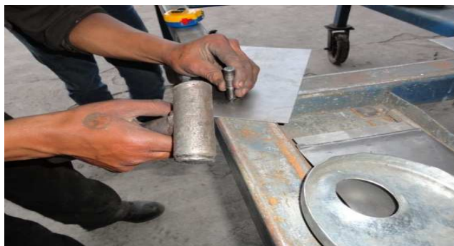
Figura 56. Señalización de compartimientos para luego cortar
