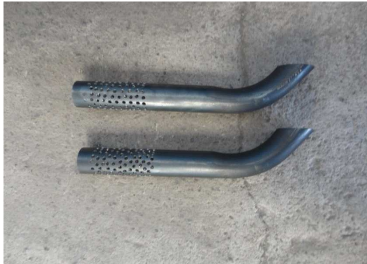
Figura 53. Caño de salida terminado de taladrar
