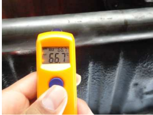
Figura 37. Temperatura exterior del caño
