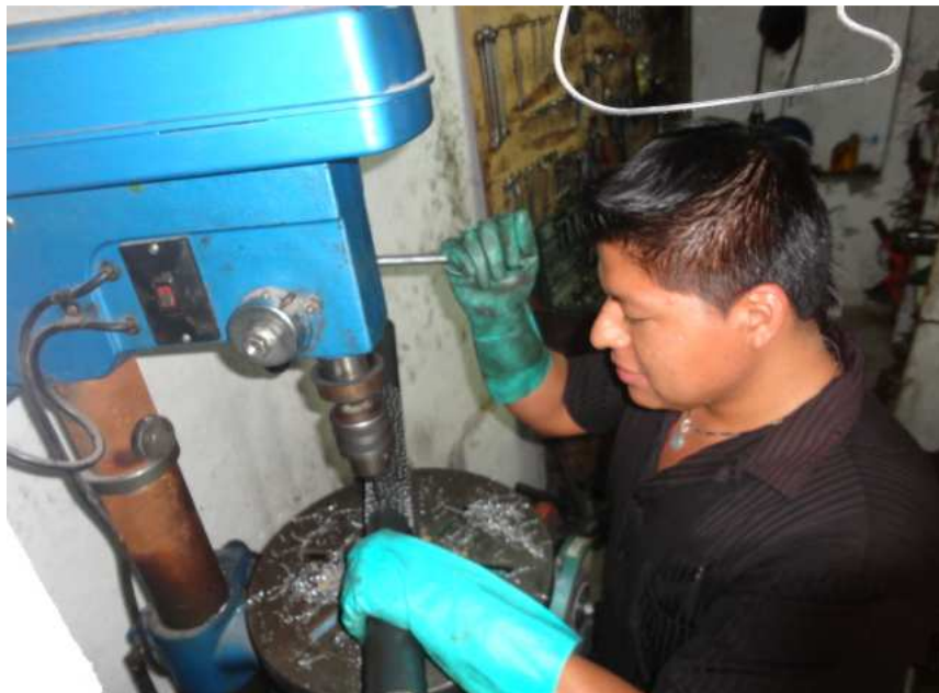
Figura 52. Taladrando agujeros del caño interior
