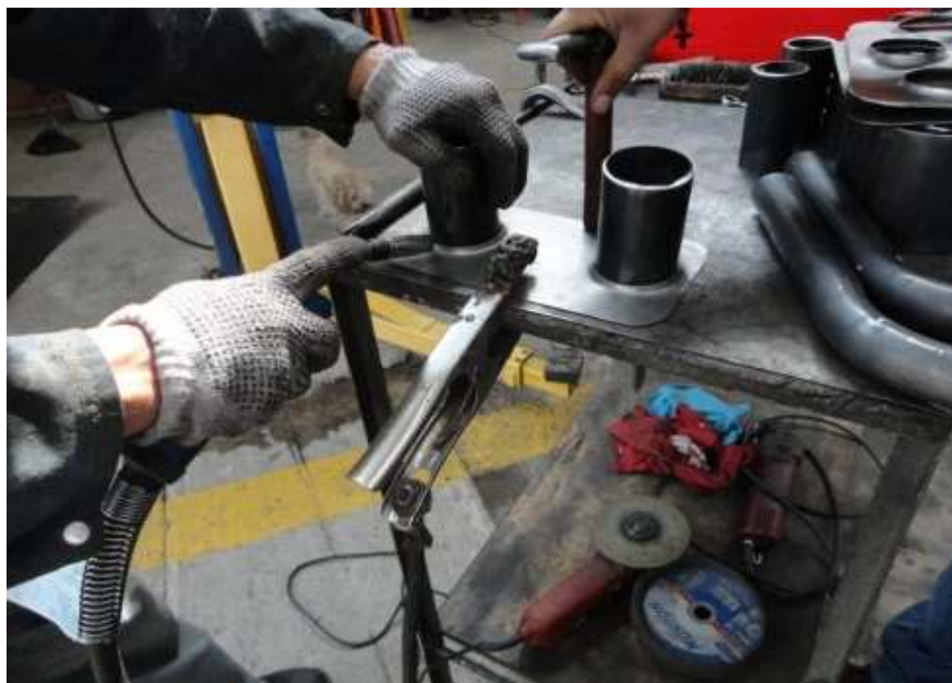
Figura 57. Soldando tubos con compartimiento
