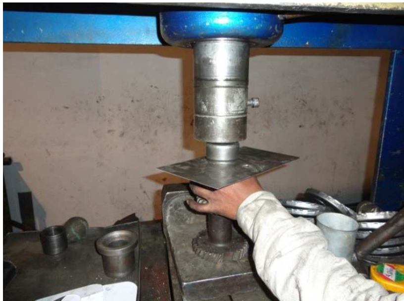
Figura 48. Prensado de tapas del silenciador
