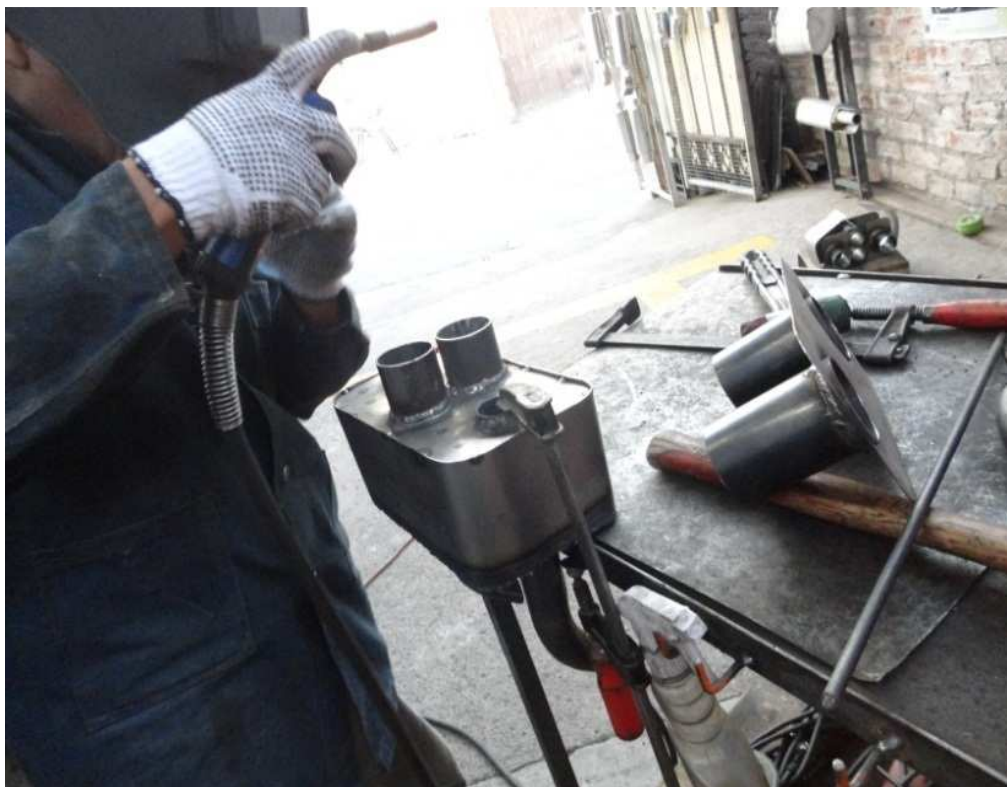
Figura 54.Ubicación de tapas en el extremo del cilindro
