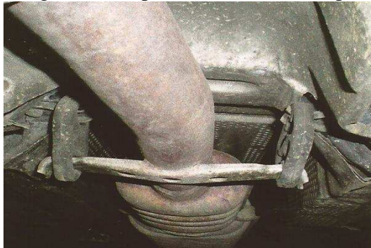
Figura 70. Soporte del tubo de escape
