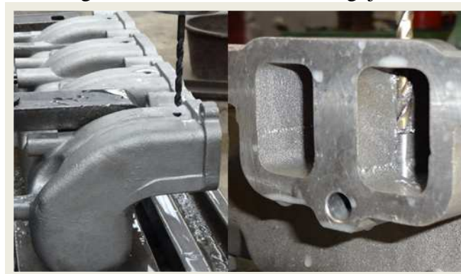
Figura 62. Mecanizado de los agujeros
