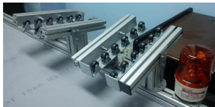
Ilustración III-33: Montaje de la baliza giratoria
