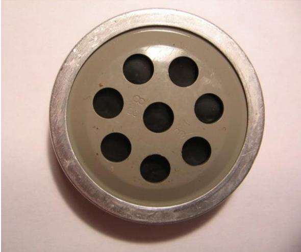
**Ilustración 2. Micrófono de Carbón**
