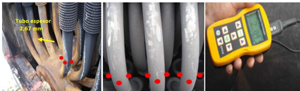
Figura 44. Ensayo de ultrasonido en haces tubulares
