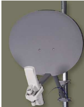
Figura.III.27. Backhaul unit (BU)
