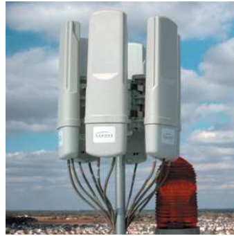
Figura.II.19. Access Point Cluster con AP
