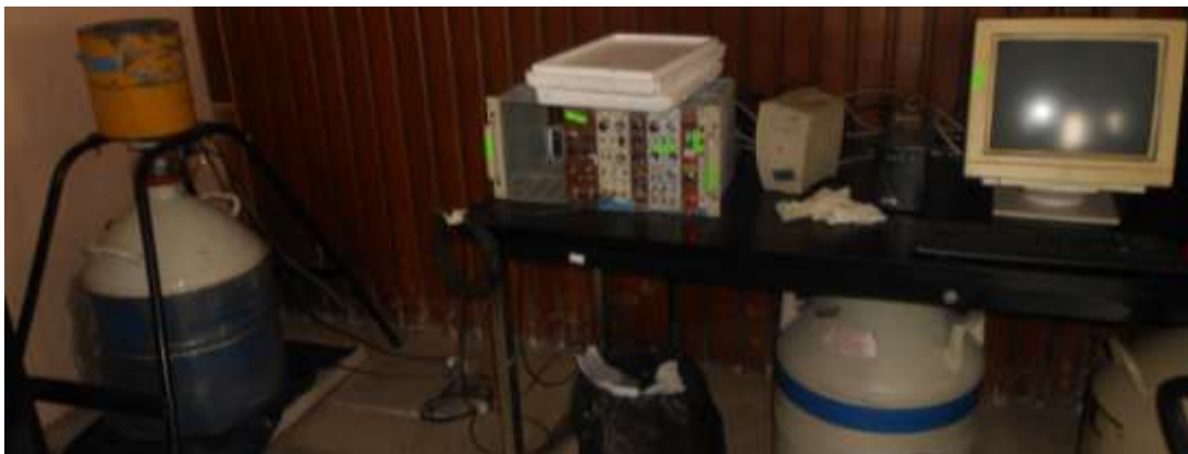
Figura 5-3: Sistema de Espectrometría Gamma CANBERRA. Fuente. Susana Guevara
