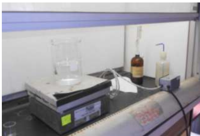
Figura 3-3: Evaporación de la muestra. Fuente. Susana Guevara
