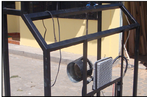
Figura 59. Instalación del impulsor
