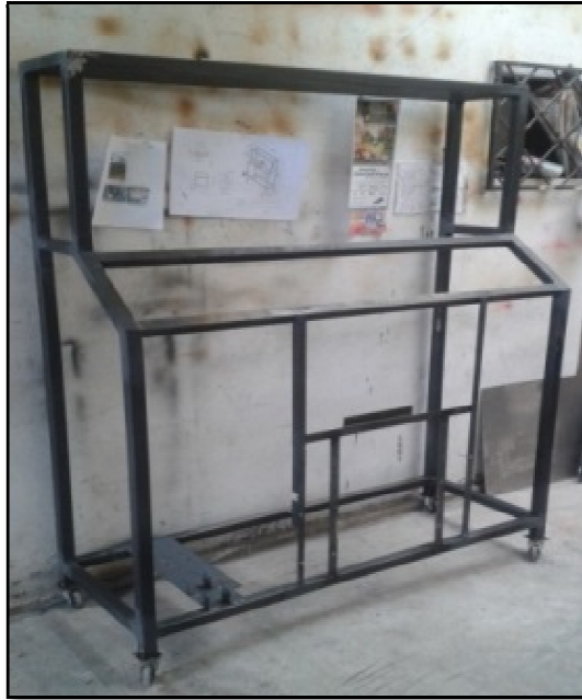
Figura 51. Estructura del banco didáctico HVAC
