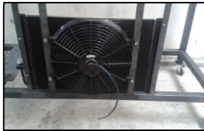
Figura 55. Instalación del electroventilador
