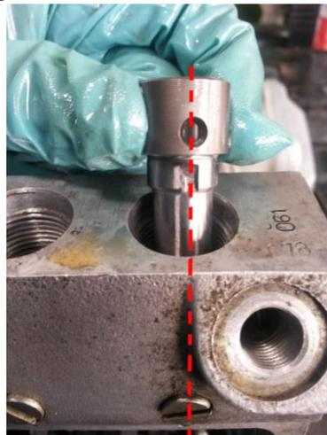
2. Instale la válvula de suministro con una nueva junta, y el racor de impulsión con su respectivo torque (29 -34 Nm).
