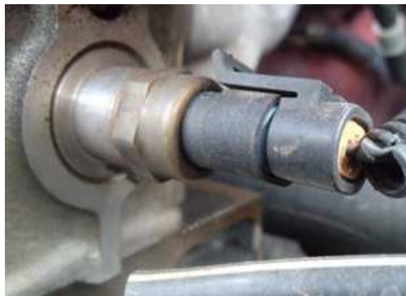
Figura 32. Ubicación del sensor ECT
