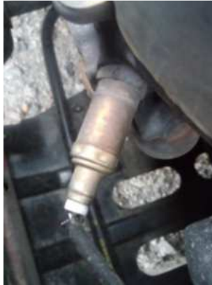
Figura 25. Ubicación del sensor de oxígeno O2
