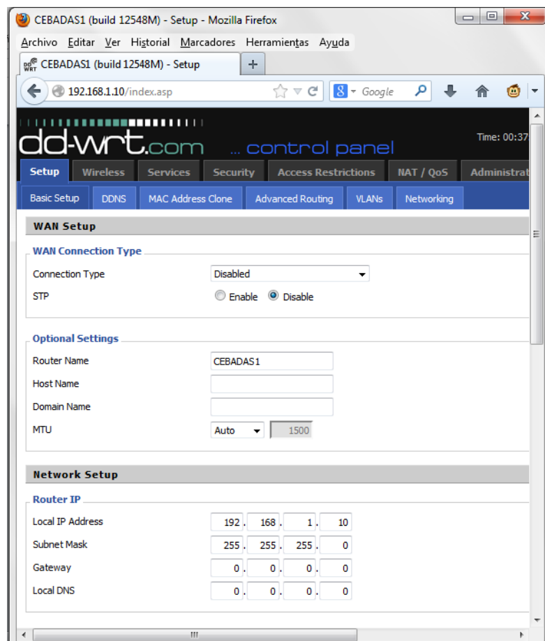
Cambiar la IP al Router CEBADAS2
