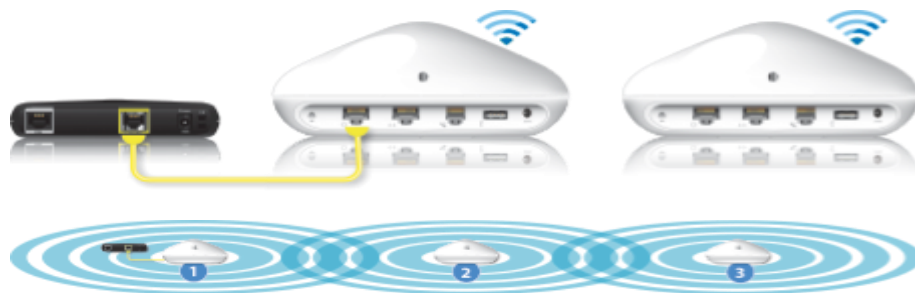
Figura N° 10: Componentes de un WDS
