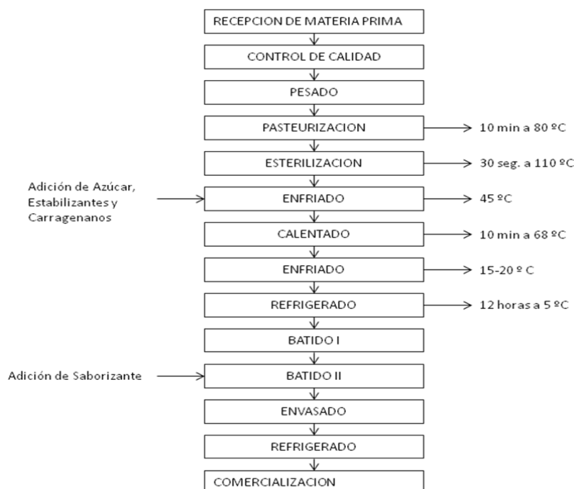
Gráfico 1. Diagrama de Flujo de la elaboración de Postre Lácteo mediante la utilización de Carragenanos.
