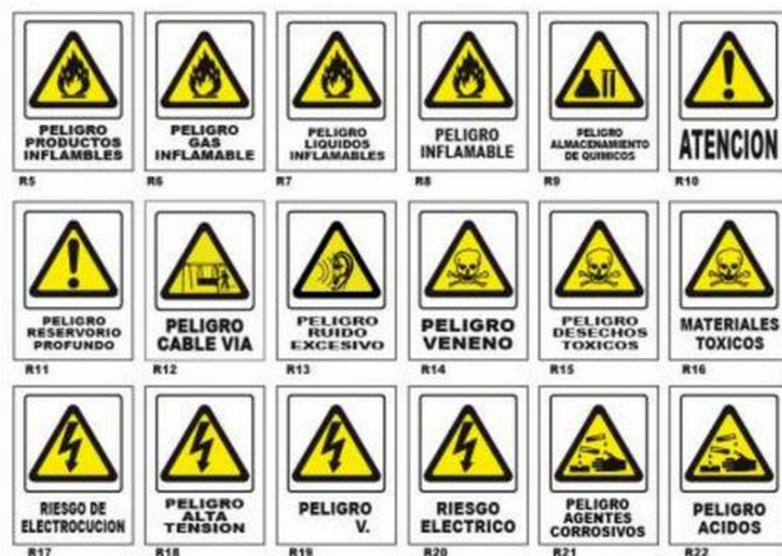
Figura 13. Señales de advertencia.
