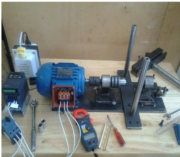
Figura 14: Proceso de montaje del tribómetro
