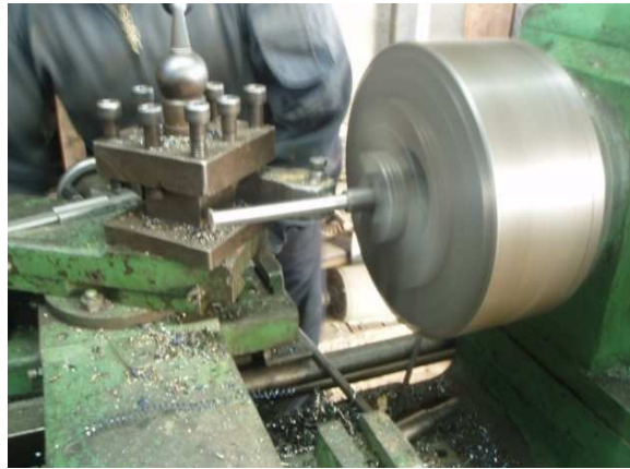
Figura 20: Desbaste de la probeta
