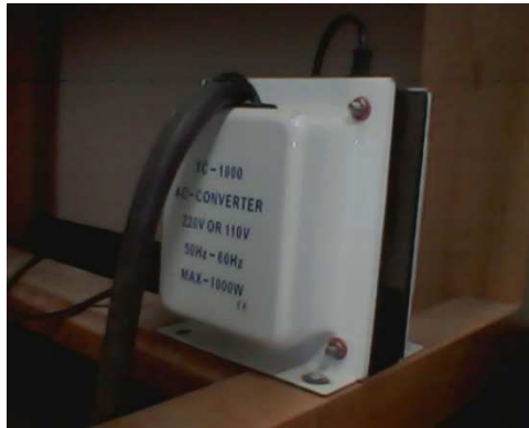
Figura 11: Transformador elevador de voltaje
