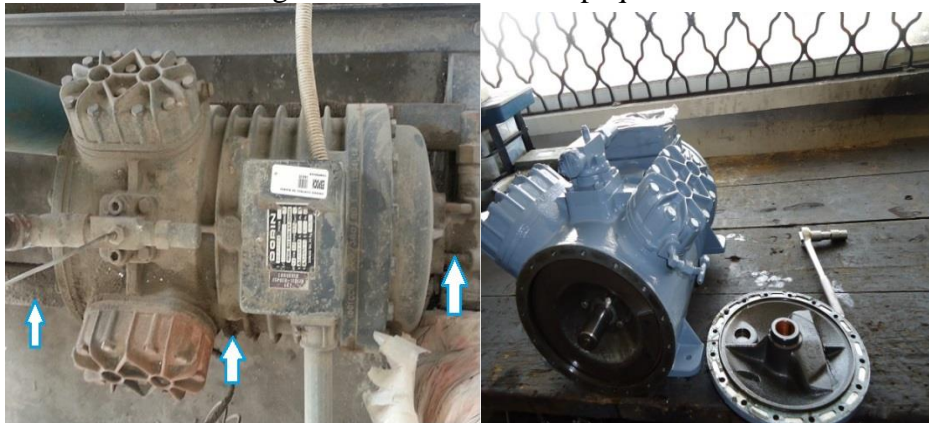
Figura 18. Cambio de empaques.
