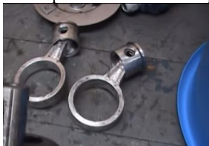
Figura 17. Inspección interna del compresor
