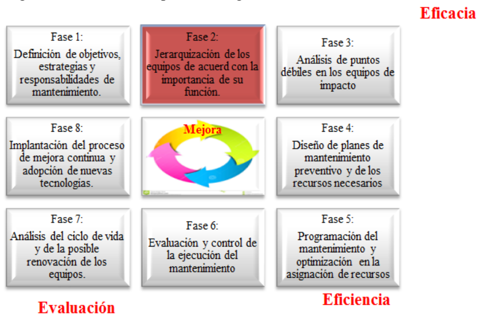
Figura 39. Modelo del proceso de gestión del mantenimiento (MGM)
