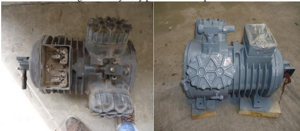
Figura 20. Lijado y pintado de compresor
