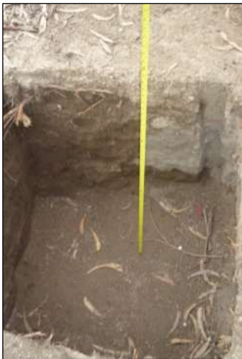
Fotografía 6. Elaboración de calicata
