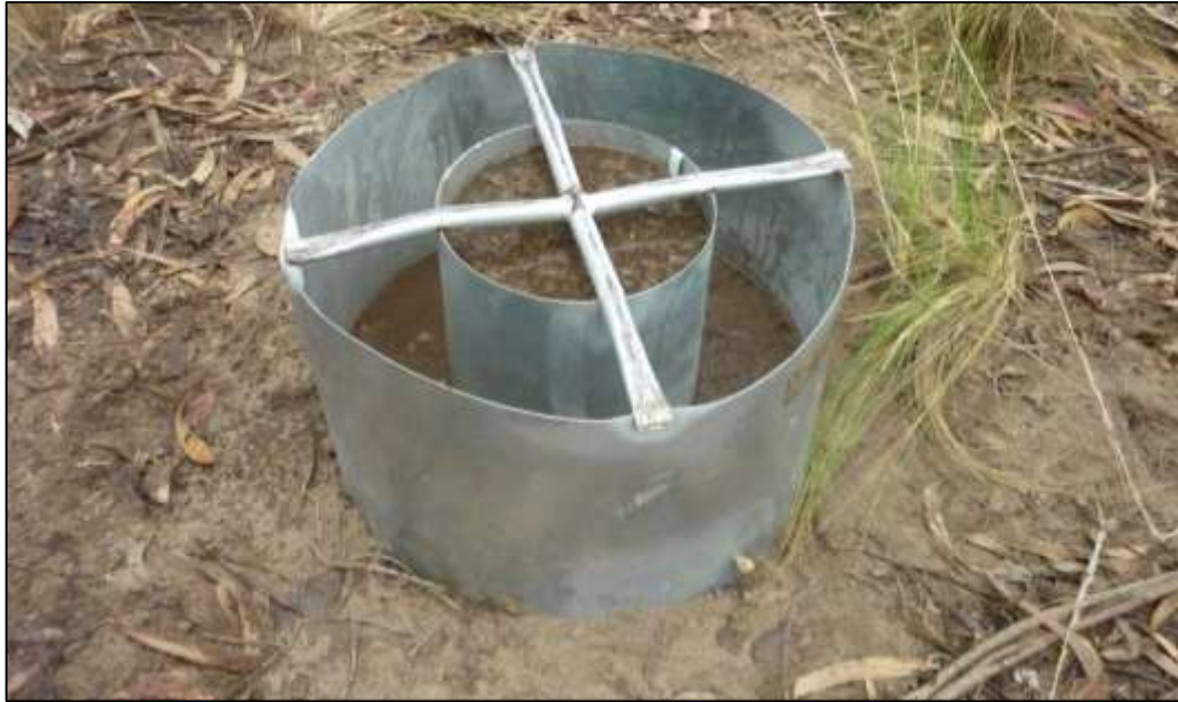
Fotografía 8. Determinación del nivel de infiltración utilizando cilindros
