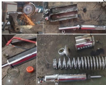
Figura 24. Seccionamiento del amortiguador
