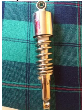
Figura 23. Amortiguador de la suspensión posterior de una motocicleta tipo custom
