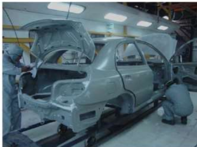
Figura 9-3: Cabina de lijado y sellado Realizado por: Angel Guamán, 2016
