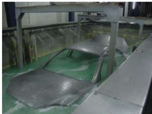
Figura 7-3: Cubas de la planta de ELPO Realizado por: Angel Guamán, 2016
