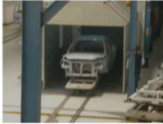
Figura 10-3: Cabina de pintura de fondo Realizado por: Angel Guamán, 2016
