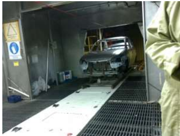
Figura 8-3: Salida de la carrocería desde el horno ELPO Realizado por: Angel Guamán, 2016
