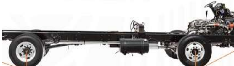
Figura 56. Tanque de aire chasis HINO Ak
