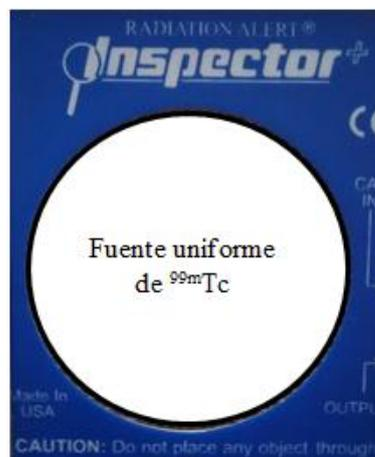
**Figura 1-5:** La figura muestra una fuente uniforme de <sup>99m</sup>Tc sobre y de igual área al de ventanilla de detección del monitor, esta fuente se obtuvo con una técnica de frotis que distribuye de manera homogénea el material radiactivo sobre papel absorbente en toda la superficie.
