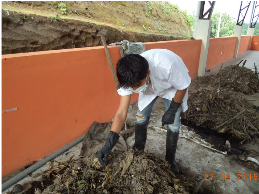
Fotografía N° 30 Monitoreo de temperatura en las pilas.
