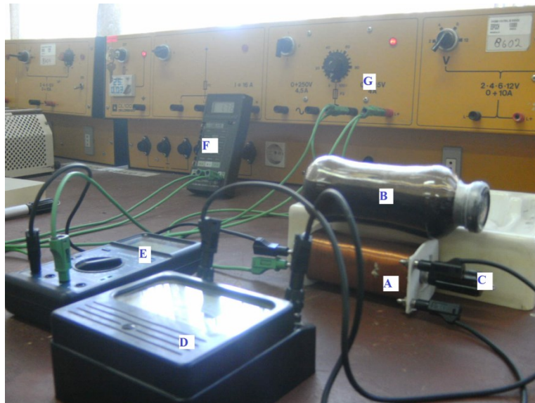
Fotografía N° 22 Estimulación magnética. A) Bobina; B) EMAs suspendidos en melaza; C) Núcleo ferromagnético; D) Gausímetro; E) F) Multímetros; G) Generador de corriente.
