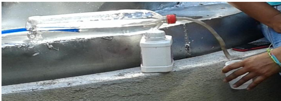
Medición de biogás por el método de desplazamiento de líquido.
