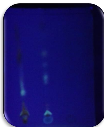
Vista al fotómetro UV Placa cromatográfica ( extracto clorofórmico)
