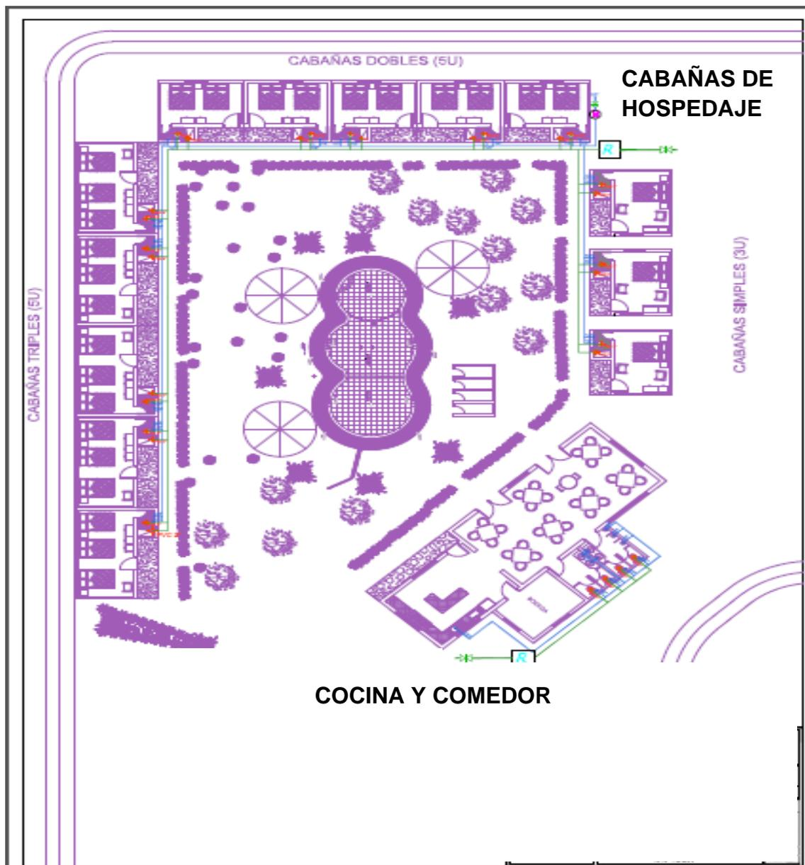
**Figura 49.** Instalaciones sanitarias y de agua potable del área de hospedaje y cocina - comedor
