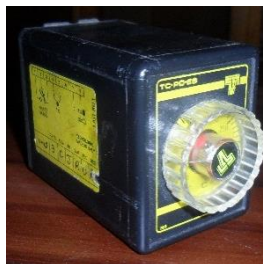
Figura 41. Relé con control de temperatura
