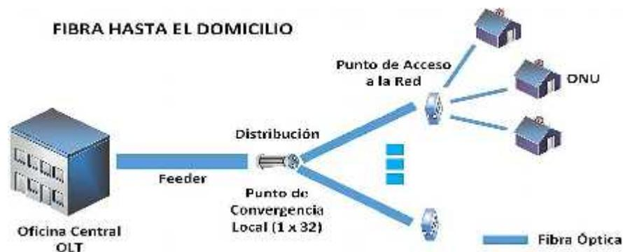
**Figura. 13-1 Estructura de Distribución FTTH**
