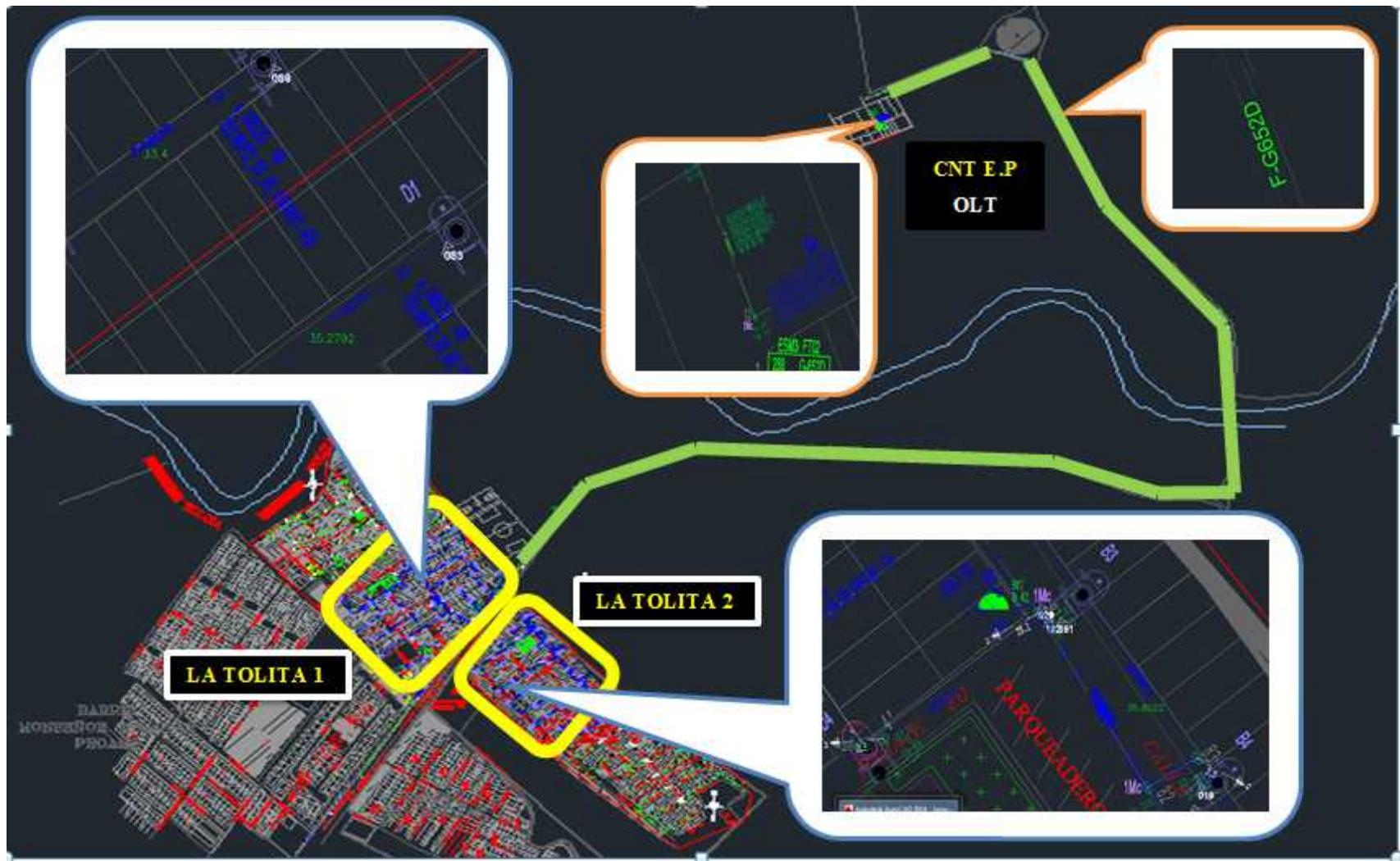
**Figura. 9-3** Diseño completo de la ODN, distribución de la fibra desde la OLT hasta las ONT's
