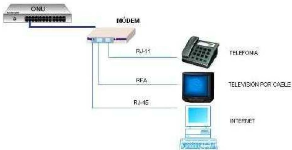
**Figura. 10-3 Conexión entre la ONU y el equipo final de usuario**
