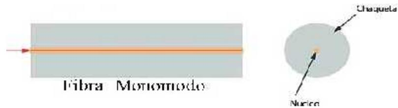
**Figura. 5-1 Propagación Fibra Monomodo**
