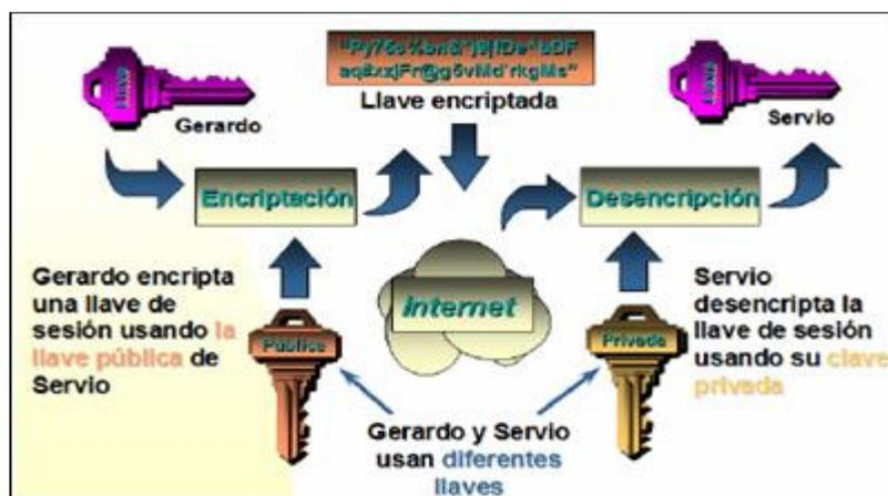
FIGURA I-II. Criptografía Asimétrica
