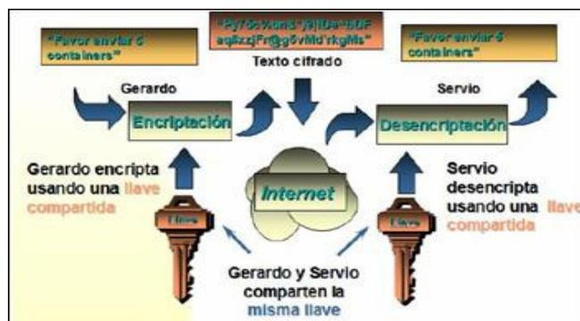
**FIGURA I-I. Criptografía simétrica**
