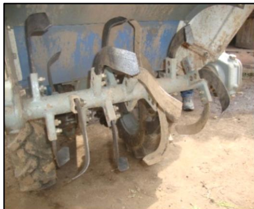
Figura 106. Inspección de las cuchillas
