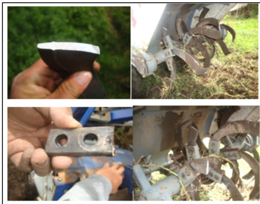
Figura 109. Mosaico de ruptura de cuchillas
