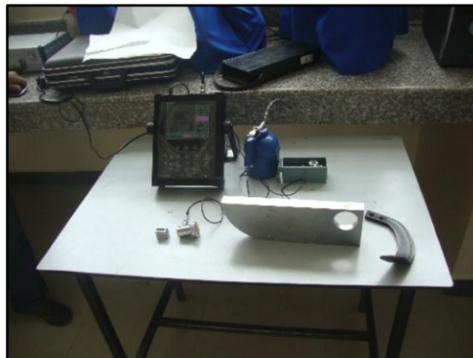
Figura 47. Equipo para el ensayo de ultrasonido
