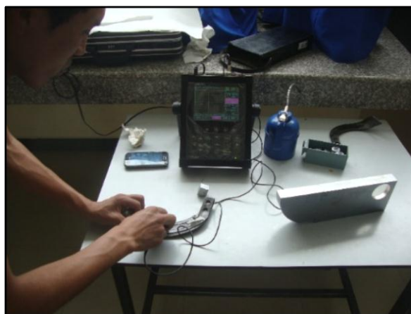
Figura 55. Búsqueda de fisuras en la cuchilla
