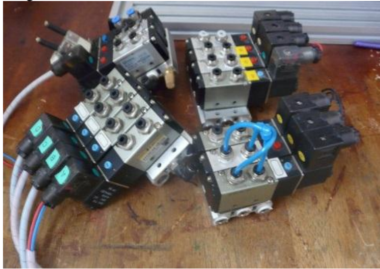
Figura 35. Electroválvulas neumáticas fuera del módulo
