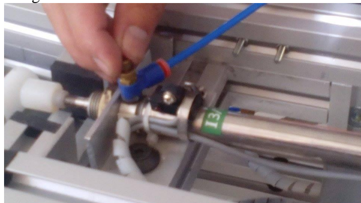
Figura 48. Calibración de la velocidad de cilindros.
