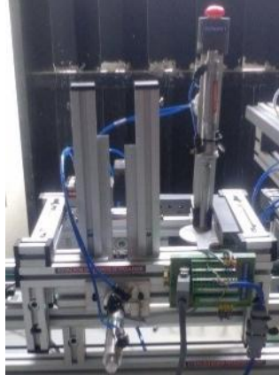
Figura 5. Estación de montaje (pasador)
