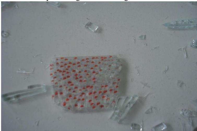
**PROBETA 2.** Ensayo de fragmentación según norma NTE INEN 1722.
