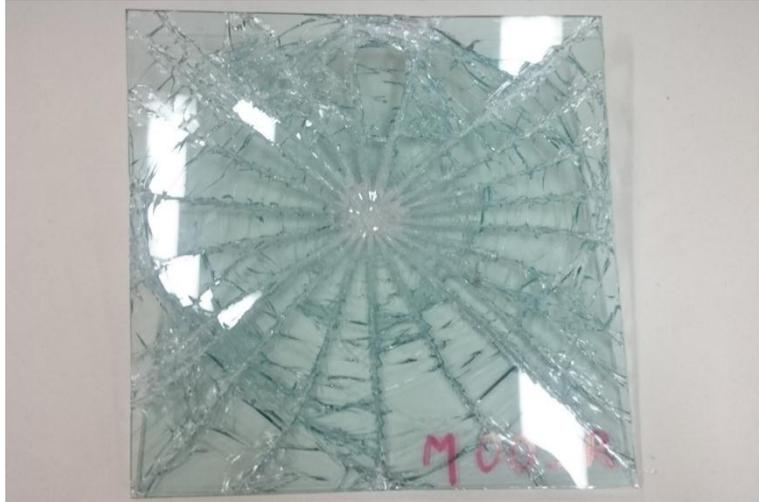
**PROBETA 4.** Ensayo de resistencia al impacto según norma NTE INEN 1724.
