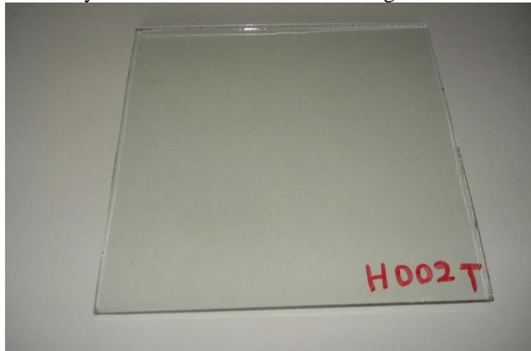
**PROBETA 3.** Ensayo de resistencia a la humedad según norma NTE INEN 1731
