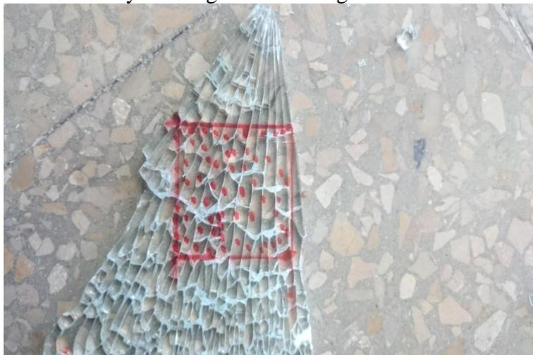
**PROBETA 6.** Ensayo de fragmentación según norma NTE INEN 1722.
