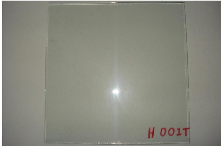
**PROBETA 2.** Ensayo de resistencia a la humedad según norma NTE INEN 1731
