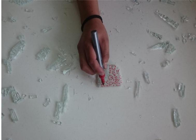
**PROBETA 4.** Ensayo de fragmentación según norma NTE INEN 1722.
