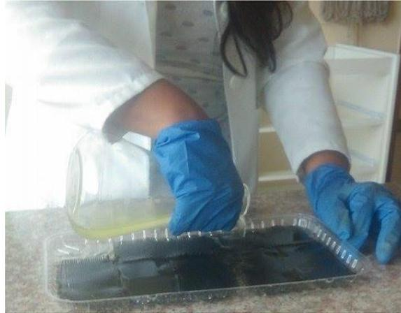
**Figura 13.3.** Electrodo cátodo sumergido en *Chlorella vulgaris* para formación de biofilm
