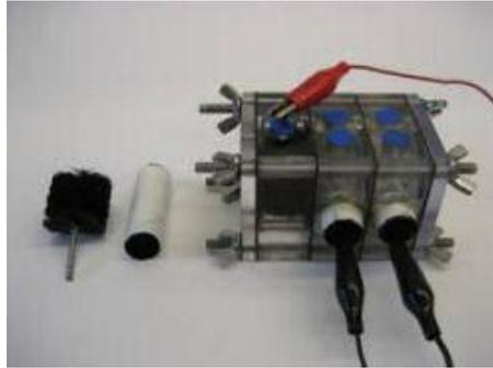
**Figura 1.2** CCM con cátodo y el ánodo especiales
