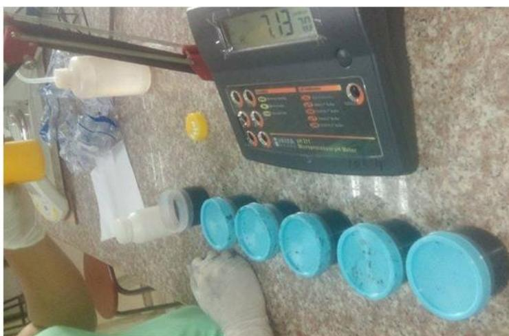
**Figura 19.3** Medición de pH de las aguas de descarga de cada celda.
