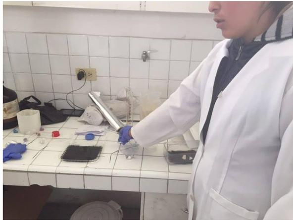
**Fotografía 28.** Preparación de la solución de  $H_2SO_4$
