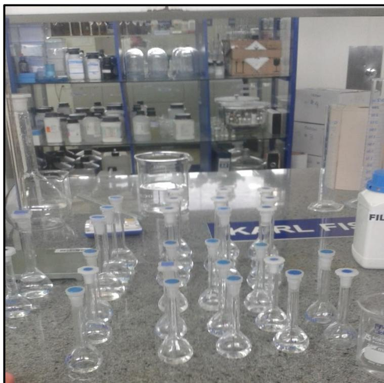
**Fotografía 3. Preparación de las diluciones de la muestra de ceftriaxona**
