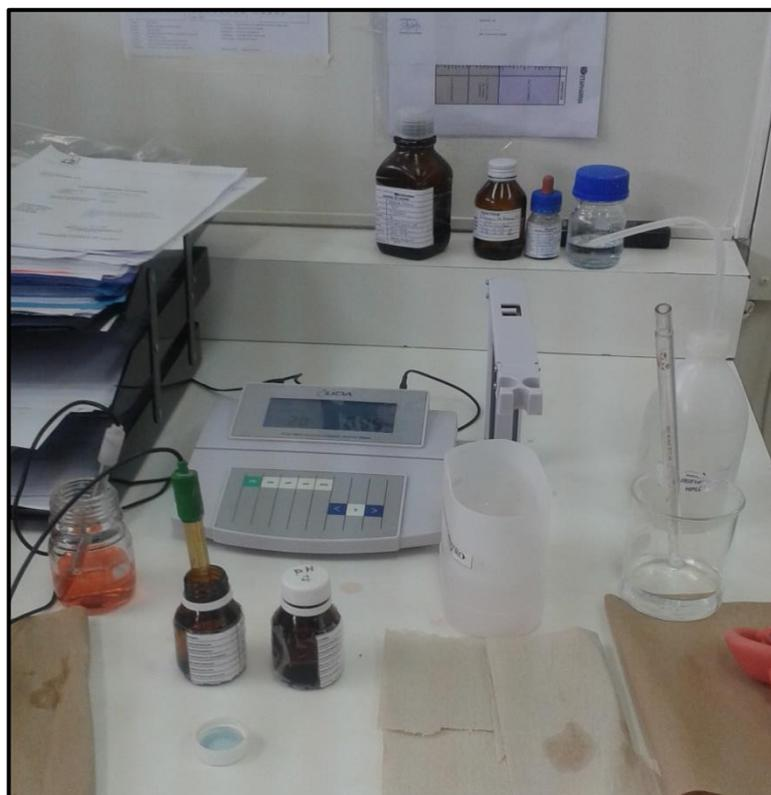
**Fotografía 4. Calibración del pH de la fase móvil**
