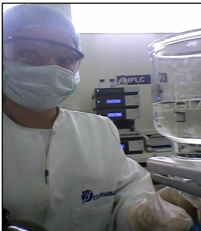
Fotografía 5. Filtración de la fase móvil por el analista
