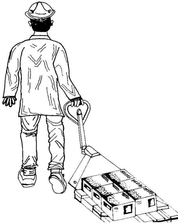
**Gráfico N° 17:** Manejo del coche hidráulico para transportar medicamentos y productos en las diferentes áreas. (Fuente: elaboración propia)
