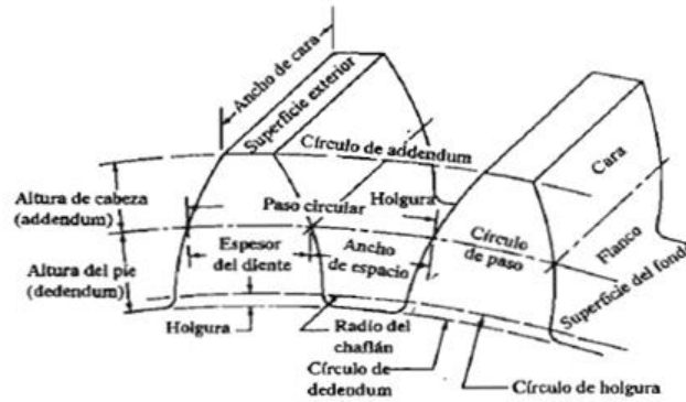
Figura 15. Propiedades del diente del engrane
