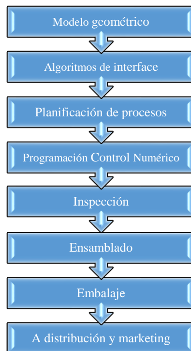
Figura 3. El proceso CAM
