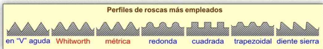
Figura 55. Perfiles de roscas más empleados
