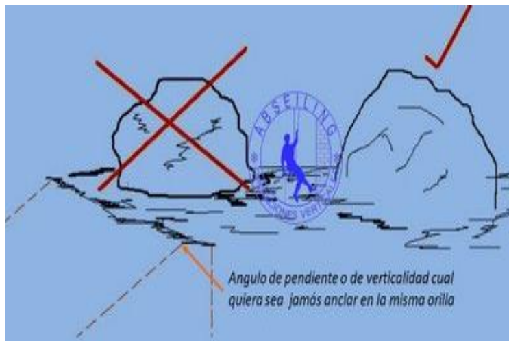
Grafico N° 69. Error de Anclaje en rocas
